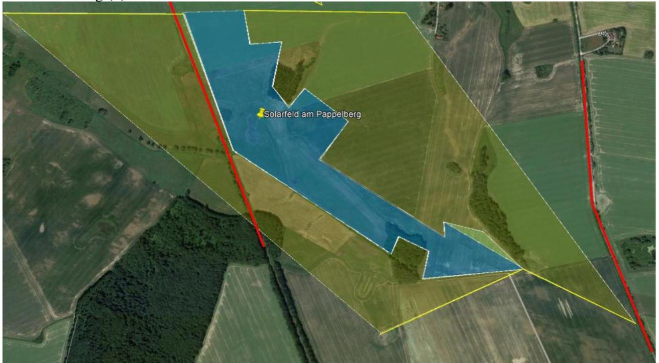
Bei der Südausrichtung ist weder Blendung in Richtung des Bahn- noch des Straßenverkehrs zu erwarten. Die Reflexionen in Richtung der Bahnstrecke liegen nicht im relevanten Sichtfeld des Zugführers. Als relevantes Sichtfeld wird im Bahnverkehr +/-20 Grad zur Fahrtrichtung erachtet.
