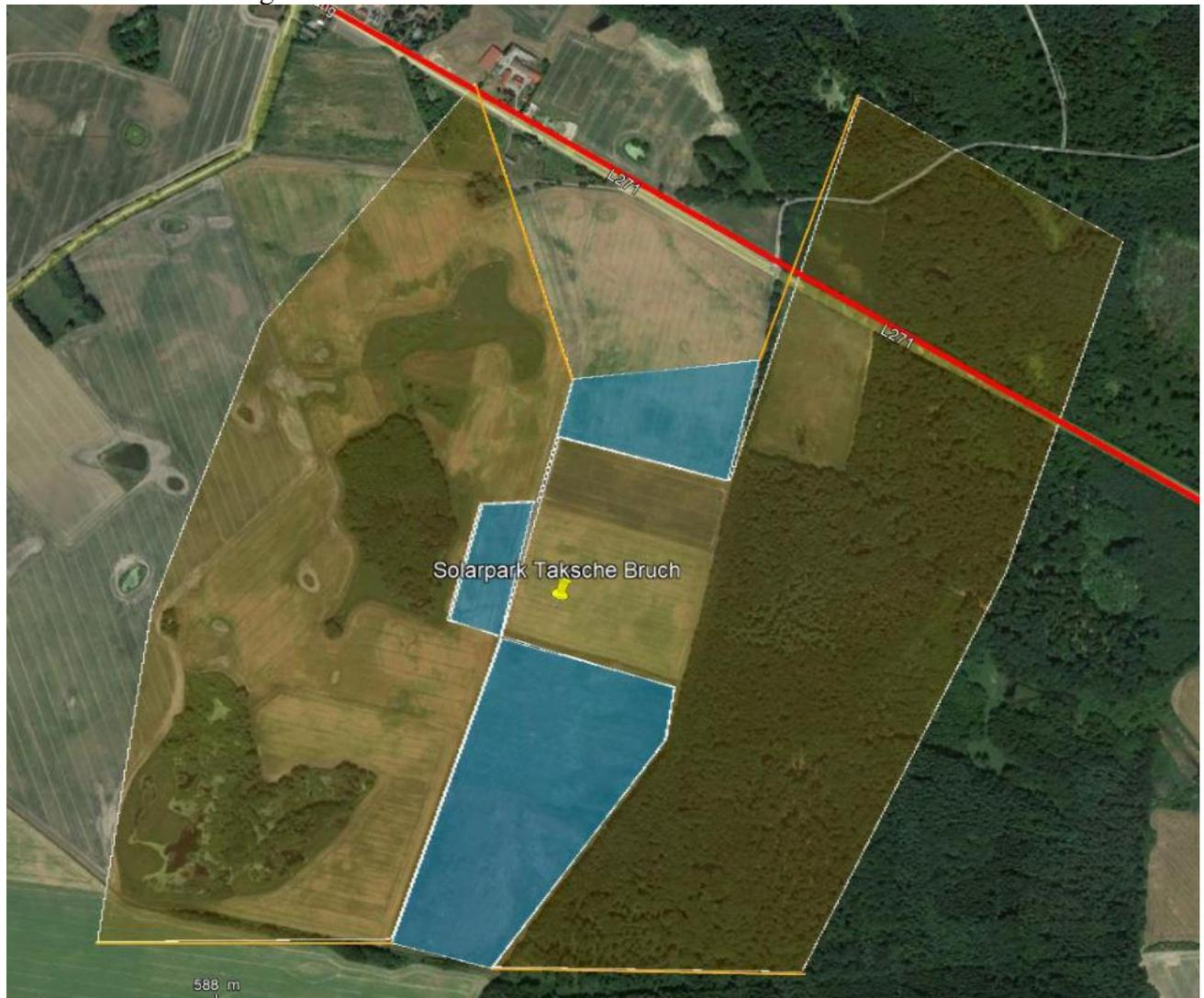
Hier ist die Blendsituation ebenfalls recht einfach zu bewerten. Die L271 wird nicht von Blendung betroffen sein. Die Bereiche, die hier markiert sind, sind von Bewuchs bereits geschützt. Somit haben Sie – bezüglich der Blendwirkung – bei diesem Park freie Wahl bezüglich der Ausrichtung der Modulneigung.
