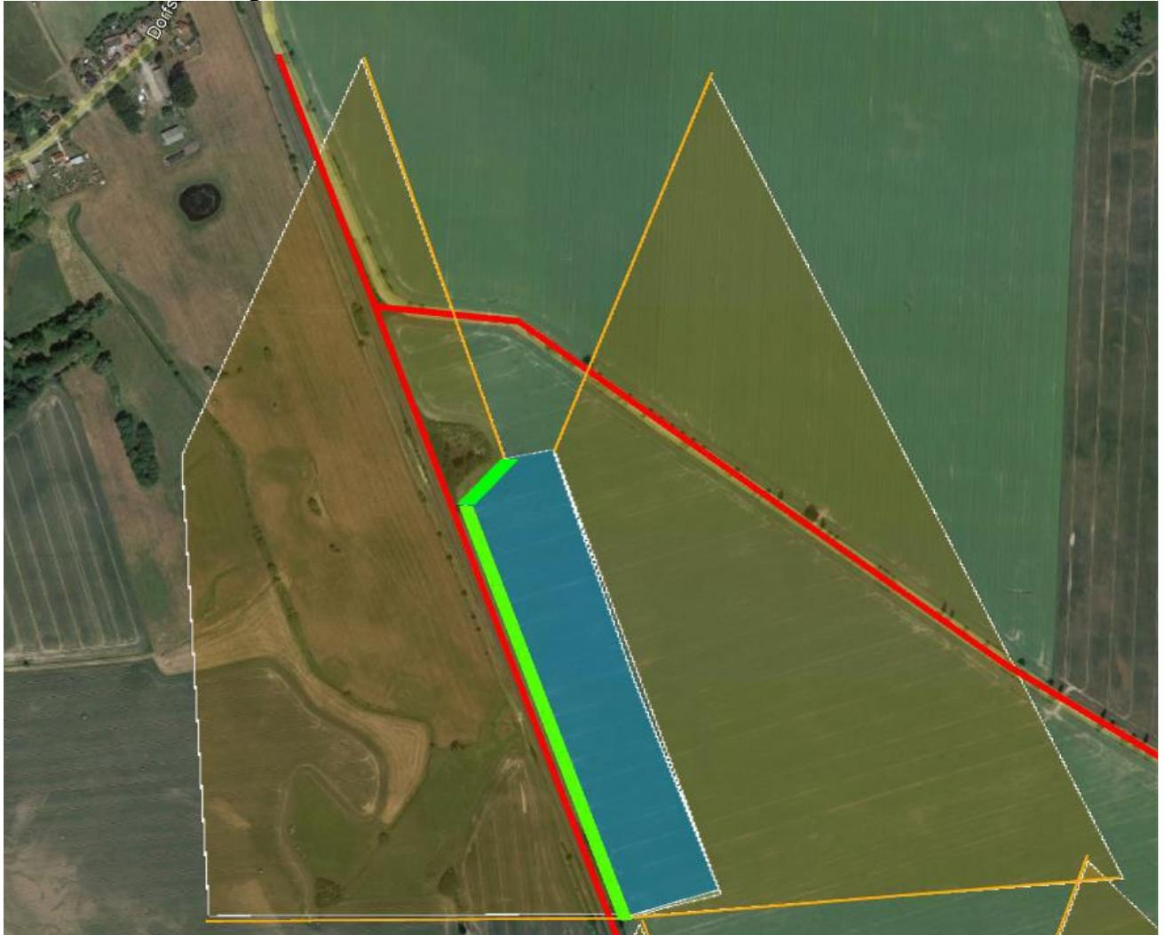
Für den Bahnverkehr liegen die Blendwinkel innerhalb des Blickwinkelbereichs der Bahn. Somit müssten für die Fahrtrichtung Norden nach Süden Blendschutzmaßnahmen erfolgen, siehe den Bereich dafür hellgrün markiert. Die Blendung zur Straße auf der östlichen Seite würde höchstwahrscheinlich nicht, auch wenn knapp, in den Blickwinkelbereich von Autofahrern treffen.
